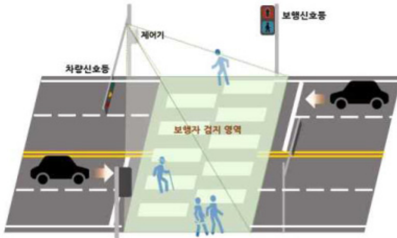
<그림 IV-3> 보행신호 자동연장시스템 개념도
